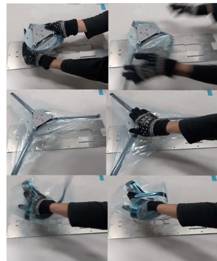
図 4 金属板バネを応用した捕獲機構試作機．接触力が受けると自動的に捕獲が完了する．
